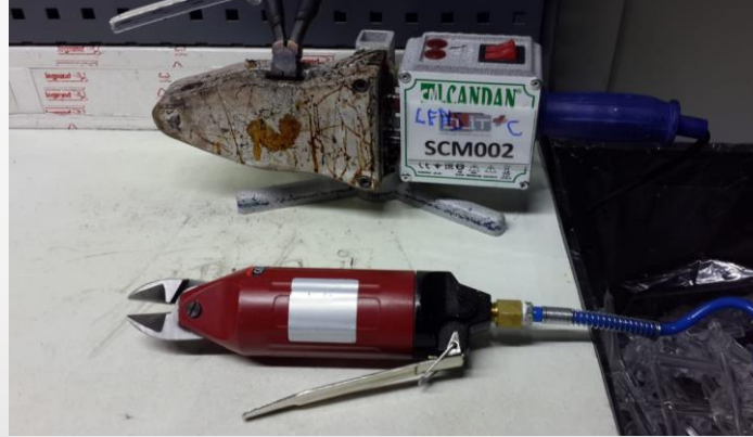
SICAK MAKAS VE ROBOT ELİ YOLLUK KESME SİSTEMİMİZ Hammadde : PC TARFLON LC 1500 (IDEMITSU)
